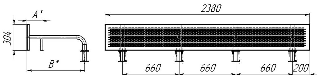
\* размер зависит от ширины переливного лотка и места его расположения
